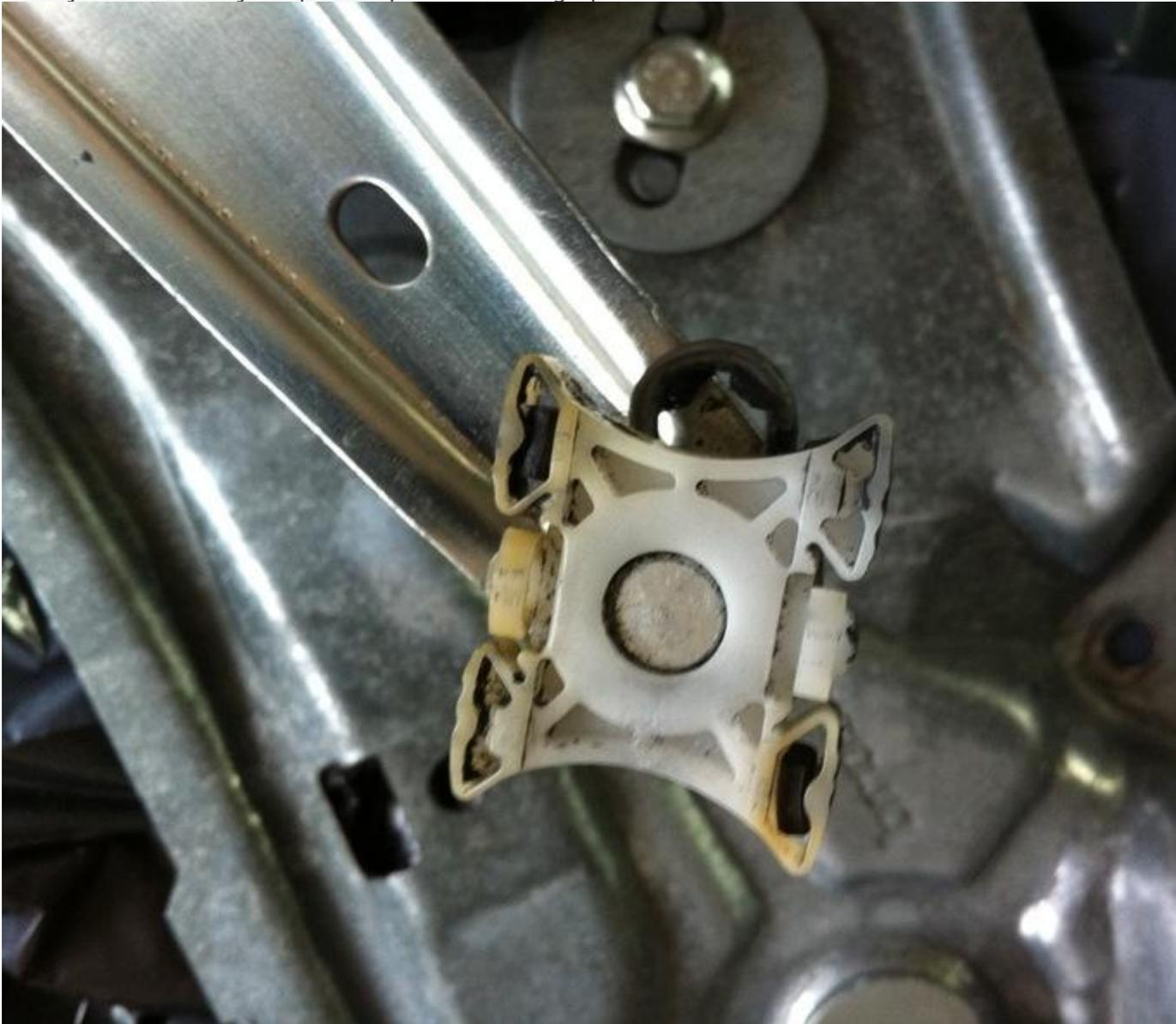
9ºDespués de la reparación engrasamos guías y tijera, después nos disponemos a regular el paño del cristal con la goma del techo, primero entornamos para ver de donde hay que apretar o soltar, para la parte delantera hay un tornillo debajo de la puerta(10mm) y otro de la trasera, aflojamos tiramos hacia donde nos haga falta y apretamos
