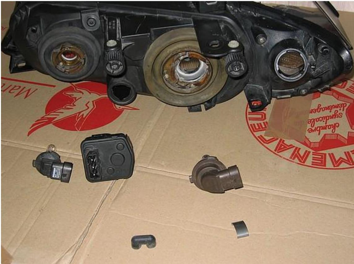
Ensuite il faut placer le feu au four (ou dans une enceinte climatique) à une température de 80°C. Metty recommande 100°C mais cela pourrait marquer le plastique transparent s'il touche la grille ou la porte du four...
